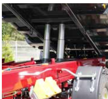
Zwei Teleskopzylinder zur optimierten Entladungssicherheit
