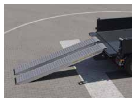
Leicht ausziehbare Alu-Rampen beim T679/4 MN ermöglichen den komfortablen Transport von kleinen Baggern.
