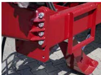
Hydr. Schrägstützfuß serienmäßig erhältlich, alternativ hydr. Stützfuß mit Kugelventil ohne Aufpreis
