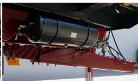
Gefederte Deichsel erhöht den Fahrkomfort
