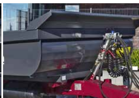
Abgerundete Vorderwand der Ladekiste zur erleichterten Entladung mittels Grabenlöffel
