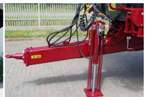
Zuverlässiger Stützfuß dank Hydrauliksystem
