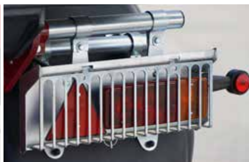
Mit Schutzgittern versehene Rücklichter zur Sicherheitsgewährleistung
