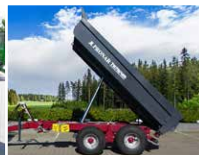
Hoher Kippwinkel ermöglicht schnelle Entladung
