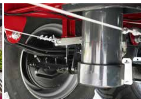
Tandemaufhängung mit Längslenkern; mit Halbachsen mit Trommelbremsen ausgestattet
