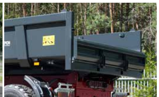
Hydraulische Heckklappe 370 mm hoch
