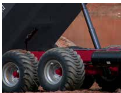
Tandem – Fahrwerk mit Trommelbremsen 300x90mm
