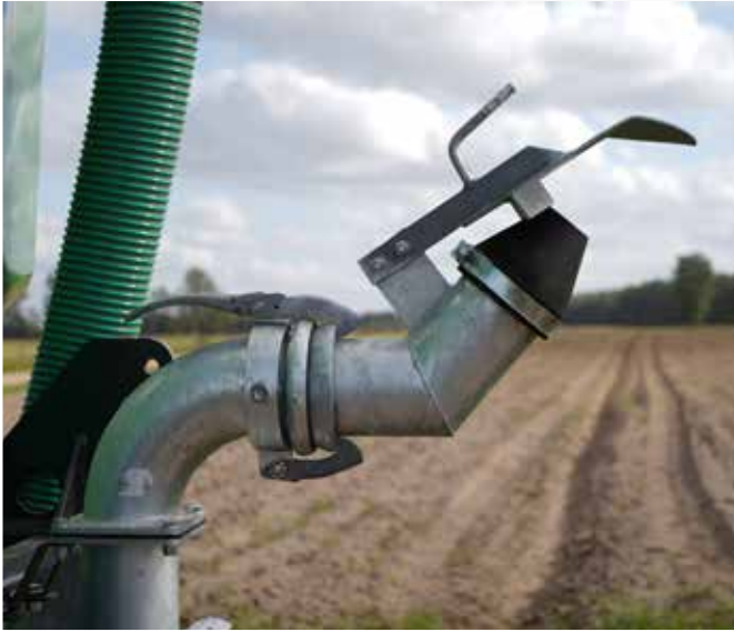
Exaktverteiler "Eisele" mit bodenwärtsgerichtetem Prallkopf ermöglicht windunabhängig breite Ausbringung
